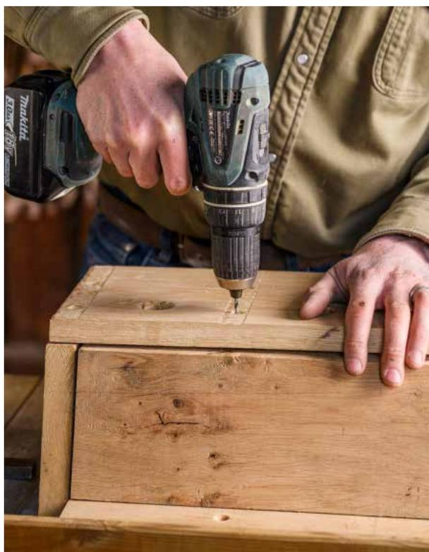
**13** Une fois le panneau frontal entièrement décoré, fixez-le à l'aide de vis en laiton de 40 mm. Vissez ensuite la planche de toit en veillant à ce que l'angle s'aligne sur les panneaux latéraux.
