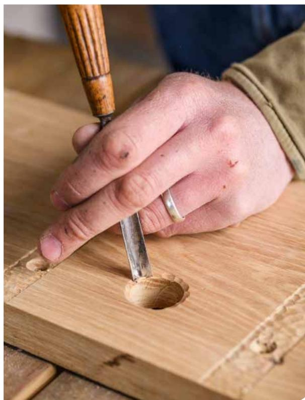
**10** À l'aide de la gouge de 8 mm, travaillez lentement autour du bord extérieur des trous d'entrée, en enlevant de petits morceaux de bois. Je travaille avec une gouge à angle droit et j'utilise le maillet plutôt que de pousser le ciseau. Travaillez lentement sur les bords.
