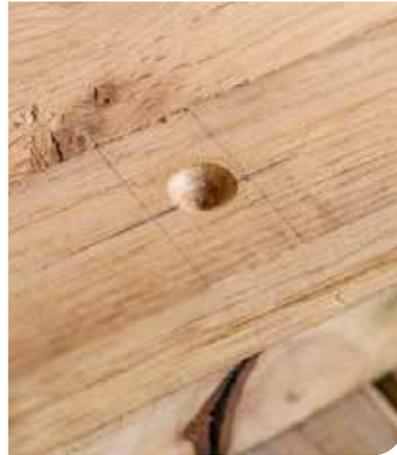
**4** Utilisez ensuite une fraise de 10 mm pour les trous orientés vers l'extérieur de façon à ce que toutes les vis ne dépassent pas du bois.
