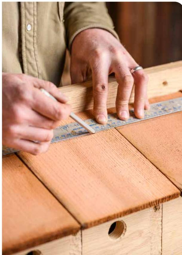
**16** Présentez les bardeaux du toit. Les bardeaux de 17 cm vont au centre, et ceux de 15 cm sur les deux bords extérieurs pour créer un débord. Les bardeaux de 7 cm couvriront les joints entre ceux plus grands. Avant de les fixer, tracez une ligne au crayon le long du sommet des bardeaux, à 5 cm du panneau arrière. Cette ligne servira à guider la position des clous.
