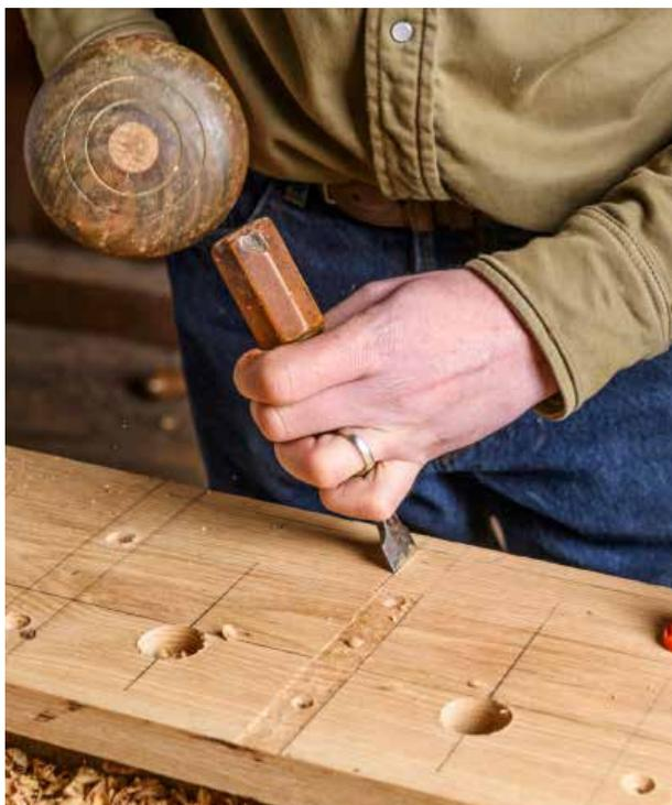
**8** Commencez par utiliser la gouge en V pour travailler le long des deux lignes de crayon. Une fois les deux côtés marqués, utilisez le ciseau plat pour approfondir l'entaille (voir p. 33 pour plus de détails). Vous obtiendrez ainsi un bon bord dans lequel vous pourrez travailler avec la gouge.
