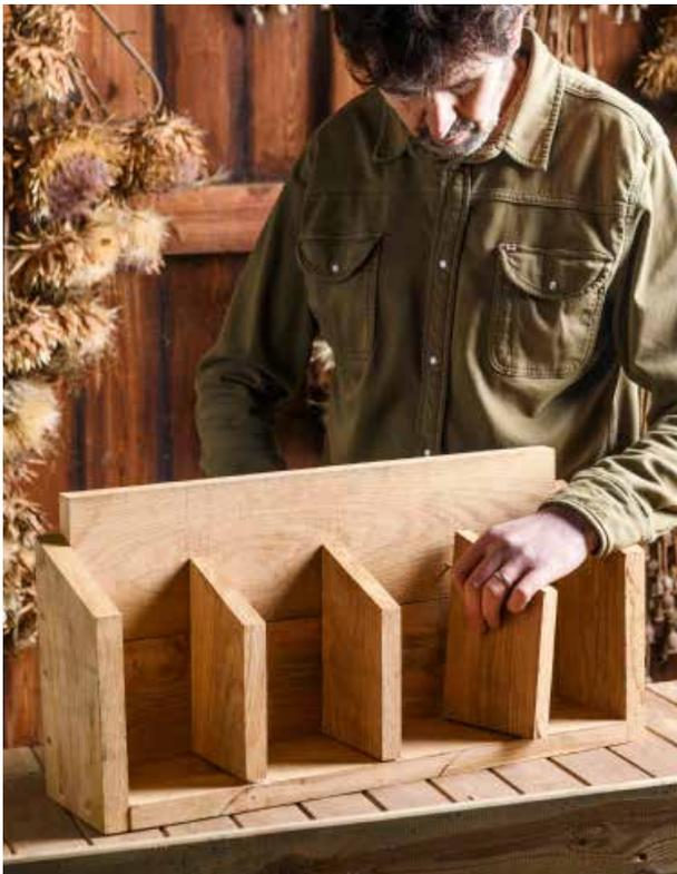
**2** Une fois tout en place, mesurez et marquez tous vos points de fixation et l'emplacement des compartiments à l'aide d'un crayon, d'une équerre et des plans ci-contre.
