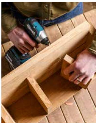
**12** Avant de fixer le panneau frontal et le toit, fixez les panneaux intercalaires à l'aide de vis en laiton de 40 mm. Fixez les vis en traversant partiellement les panneaux arrière prépercés de façon à ce que vous puissiez voir la vis. Cela permettra d'aligner les intercalaires.
