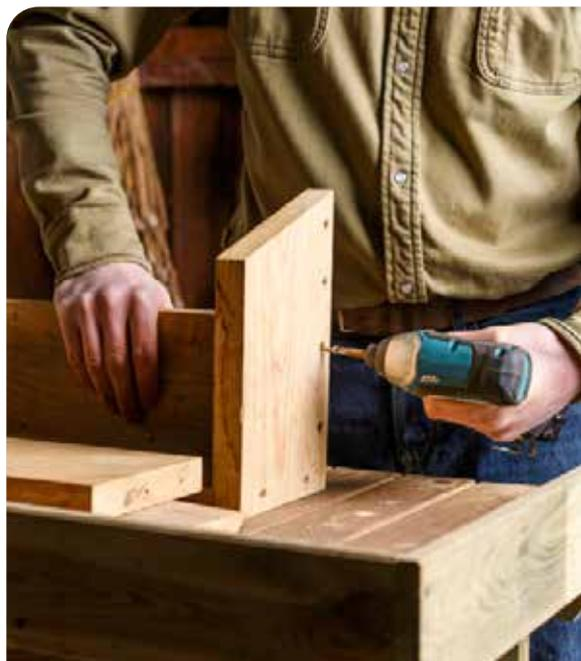
**11** Vous pouvez maintenant assembler le nichoir. Posez-le sur l'établi, puis présentez les deux côtés en les fixant au fur et à mesure à l'aide de vis en laiton de 40 mm. Fixez ensuite les deux panneaux arrière aux côtés et à la base.
