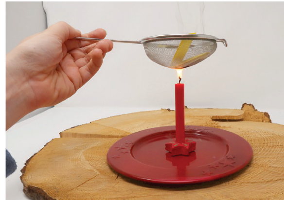
Abb. 1.7 Sieb als Feuersperre. Das Papier im Metallsieb brennt nicht!
